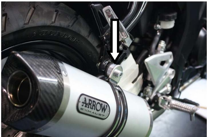
IT · Per terminali Race Tech: Serrare il terminale mediante fascetta interponendo con la pedana lo spessore fornito
