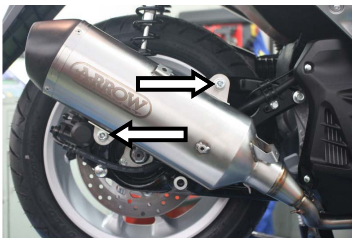
Innestare il terminale e serrare gli attacchi (2) al telaio Fit Arrow silencer to the collector and secure the mounts to the swingarm plate
