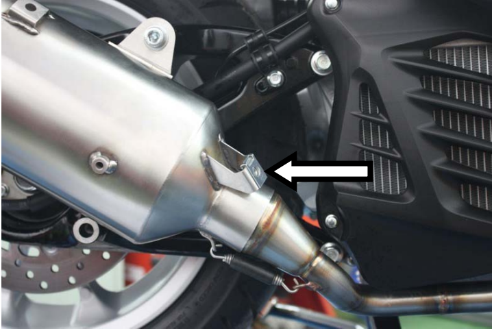
Inserire la clip nell'attacco anteriore del terminale Fit the caged nut to the cover mount, as shown above
