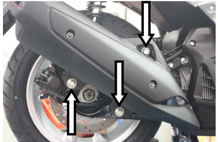
Svitare le viti indicate (3) e rimuovere lo scarico originale Remove the 3 screws shown above and remove OE silencer
