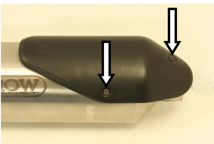
**IT** · Solo per terminale XN: Inserire la clip nell'attacco anteriore del terminale ed avvitare la protezione
