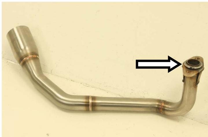
**IT** · Alloggiare la guarnizione originale nell'innesto del collettore
