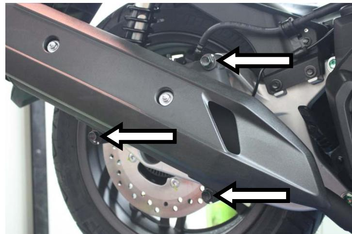
**IT** · Svitare le viti indicate (3) e rimuovere l'impianto di scarico originale
