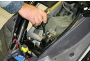
Desserrer et déposer les vis de fixations pot ou cylindre a l'aide d'un cliquet et douille de 10.
