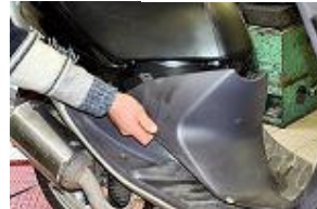
Pour retirer le cache, baisser la selle et d'éclipser les cotes en faisant basculer vers l'avent.
