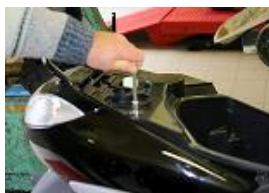
Uniquement sur TREKKER et Speedfight retirer les vis de 6 supérieures du coffre a l'ai de la clef a pipe de 10 mm
