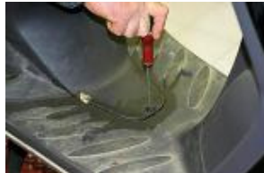
Retirer les vis inférieures du cache batterie a l'aide d'une clé de 20 ou d'un tournevis plat
