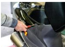
Retirer les deux vis supérieures du cache batterie à l'aide d'une clé torx de 20 ou d'un tournevis plat.
