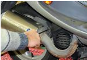
Déposer de la vis supérieures (BTR de 8) fixation du pot d'échappement au carter.
