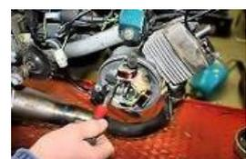
Déposer les vis de fixation du stator.
