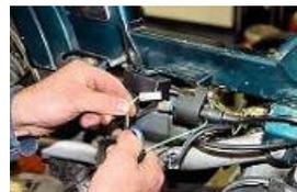
Débrancher les câbles du stator d'origine de la bobine hôte tension.
