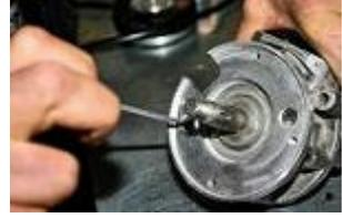
Fixer la platine à l'aide des 2 vis 5 x 20 têtes fraisées fournies, en contrôlant que la sortie de câble est en haut à gauche.
