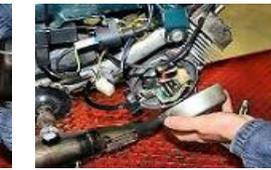
Déposer le volant magnétique.
