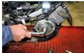
Tourner le rotor dans le sens inverse jusqu'à son blocage et desserrer l'écrou avec une clé de 16.
