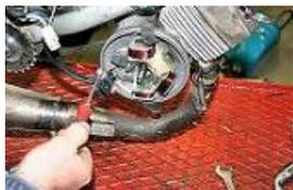
Déposer les vis de fixation du capteur.
