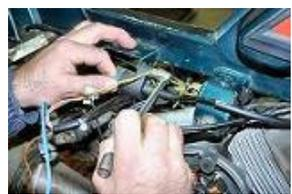
Serrer les masses ensemble pour fixer la bobine avec une clé de 8.
