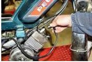
Connecter le câble bleu du stator avec le câble blanc du connecteur.
