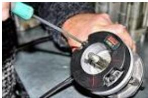
Serrer le stator avec les 2 vis de fixation 5x30 fournies.
