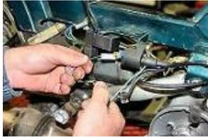
Dégrafer le CDI d'origine de sa protection caoutchouc et le retirer.
