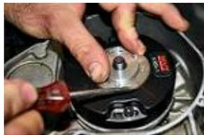
Desserrer le bloc piston et positionner une pige de calage et chercher le PMH. Au point haut contrôler la position de votre pige de calage et régler l'avance à 1.5 mm puis tourner le vilebrequin pour venir en position contre la pige. Placer le repère rouge du rotor en face du repère droit du stator.
