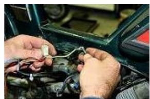
Positionner la masse du stator MVT avec les masses d'origine sur la vis de fixation de la bobine.
