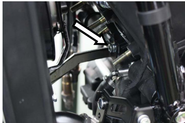
**IT** · Fissare la staffa radiatore fornita al motore mediante vite originale
