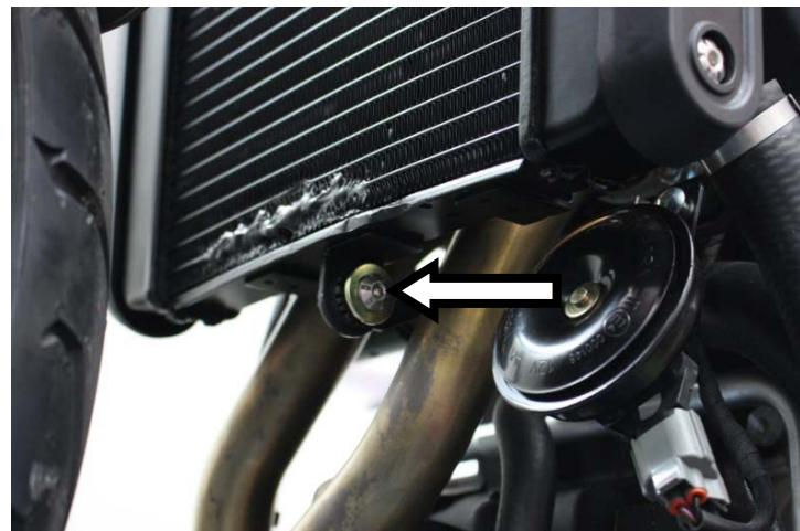
**IT** · Svitare la vite di fissaggio radiatore
