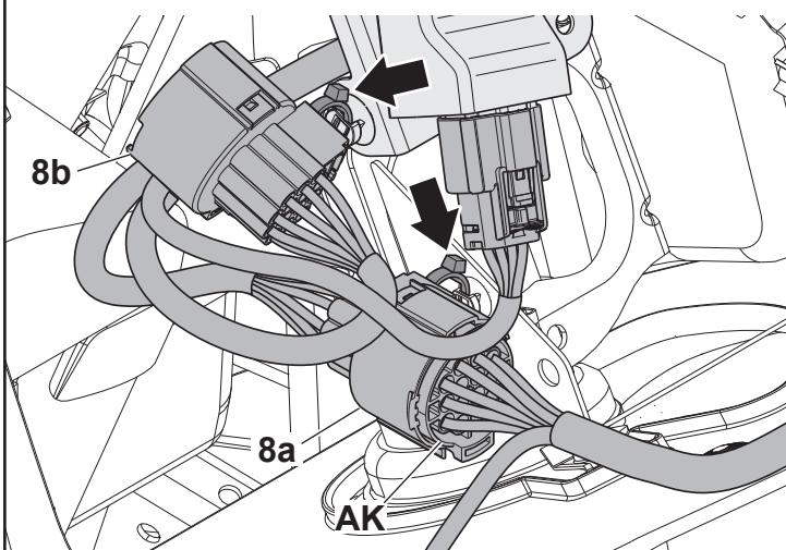
**I** Collegare il connettore **8a** della briglia **8** al connettore **AK** del cablaggio veicolo e il connettore **8c** al dispositivo accessori riscaldanti.
