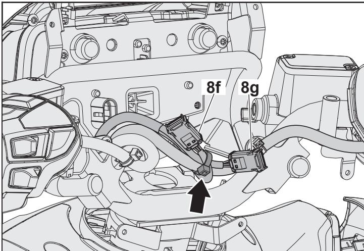
**D** Die Kabelstecker **8f / 8g** mit einer der dem Kit beiliegenden Schellen am Lenker befestigen, wie auf der Abbildung gezeigt wird.
