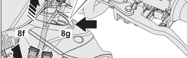
**G** Συνδέστε τη φίσα **8a** της καλωδίωσης **8** στη φίσα **AK** της καλωδίωσης του οχήματος και τη φίσα **8c** στο σύστημα θερμαινόμενων αξεσουάρ.
