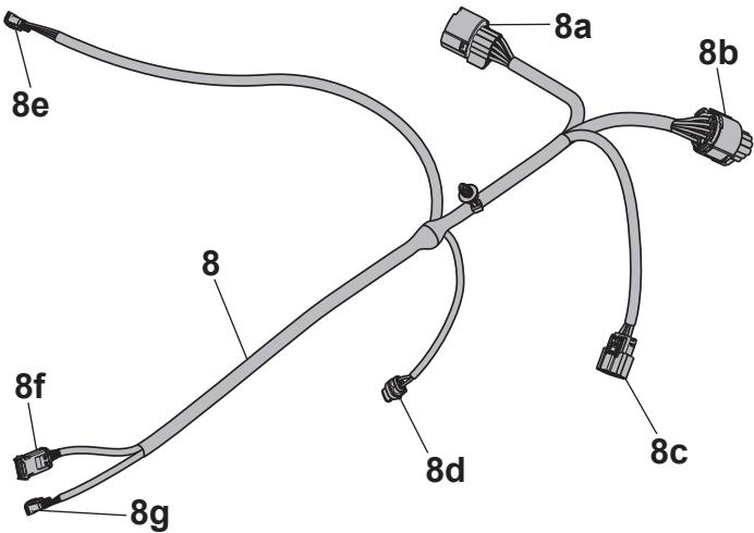
Angefangen von der rechten Fahrzeugseite den Teil des Kabelstrangs **8** mit den Kabelsteckern **8d / 8e / 8f / 8g** unter dem Bügel der Vorrichtung zur linken Fahrzeugseite hin durchführen. Dabei darauf achten, die Schelle am Kabelstrang in der vorgesehenen Bohrung des Bügels wie auf der Abbildung gezeigt zu befestigen.
