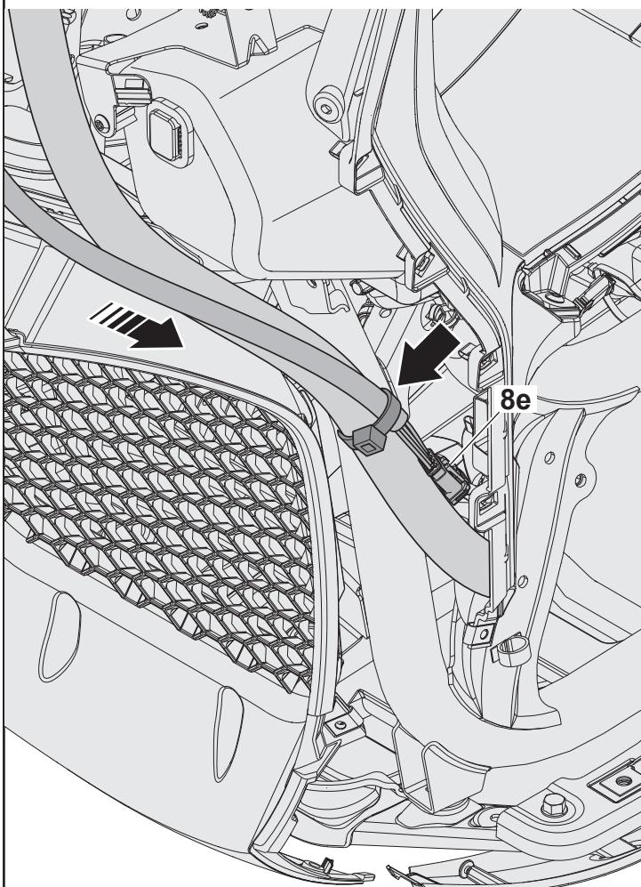
**E** Unir los conectores **8f / 8g** al manillar utilizando una de las abrazaderas que se suministran con el kit, como se muestra en la figura.
