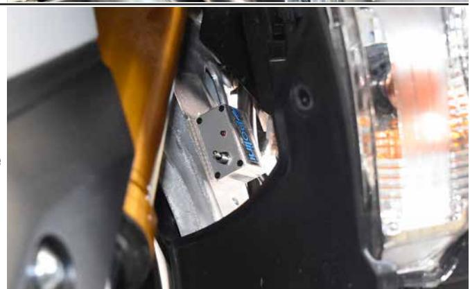
**- ATTIVAZIONE DEL DISPOSITIVO - ATTENZIONE!** È fondamentale attivare il dispositivo a motore spento. L'attivazione a motore acceso comporterà l'accensione della spia "avaria motore" disattivabile solo presso un concessionario ufficiale Yamaha. Girare la chiave senza avviare il motore. Attivare il dispositivo tramite la leva (led acceso) e accendere il motore (verificare che il led rimanga acceso). Il TCS dello scooter è ora disattivato. Rimontare le plastiche dello scooter.
