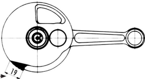
Partie à enlever avec meule, arrondir les arêtes aiguës avec toile abrasive.
