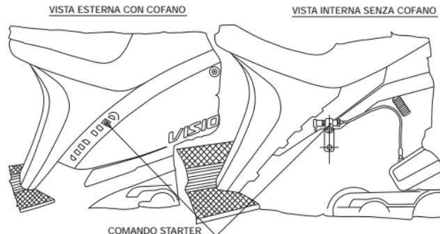
Collegare le relative trasmissioni di comando facendo adeguata registrazione dei fili. Raccordare il tubetto del carburante al carburatore e il tubetto della lubrificazione al nuovo collettore, facendo attenzione che non vi siano perdite o impedimenti al passaggio dell'olio di lubrificazione del motore.
