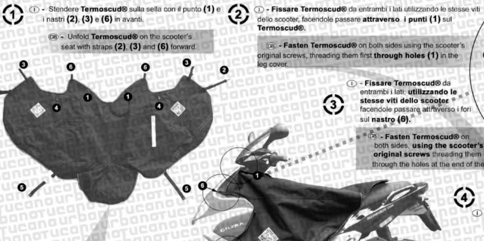
**1** - Utilizzare i punti di regolazione dei nastri **(2)**, e **(3)** per **adattare Termoscud® alla forma dello scooter e metterlo bene in tensione**, così da evitare lo sventolio e l'entrata di spifferi.
